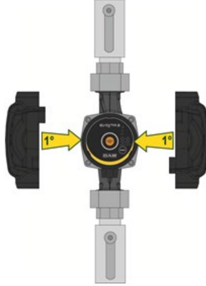
Resim 7: Pompa gövdesinin yalıtımı
