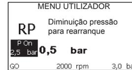
Figura 17: Programação da pressão de rearranque
